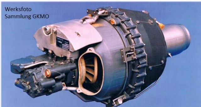
Die T117, das erste in Deutschland nach 1945 entwickelte, zugelassene und 1990 in den Serienbetrieb gegangene Turbinen-Luftstrahltriebwerk
